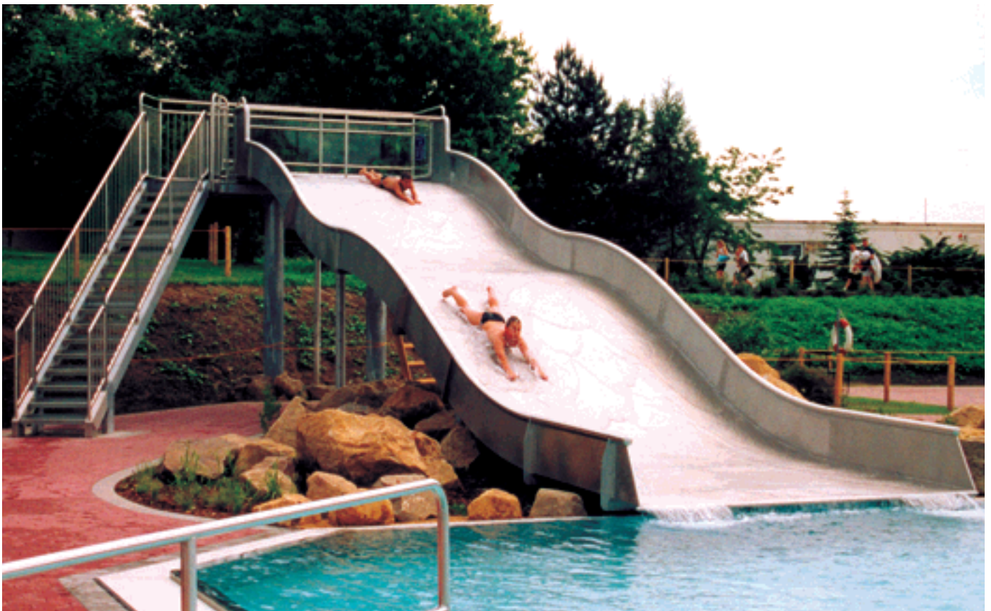
Breittrutschbahn aus V4A Edelstahl, mit Hügel- und Talbögen ca. 3 m breit, nahtlose und glatte Übergänge, seitliche Wangenhöhe 0,5 m. Auch in 2 m Breite lieferbar.
