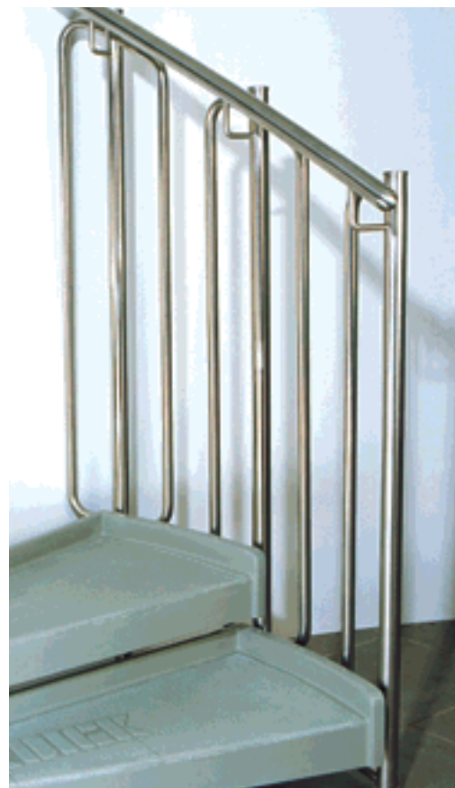
Wendeltreppendetail , Stufen aus GfK, grau, 3-seitig um 60 mm hochgezogen gegen Tropfwasser, der Antritt um 80 mm nach unten gezogen, Geländer aus V4A Edelstahl, Harfen-förmig
