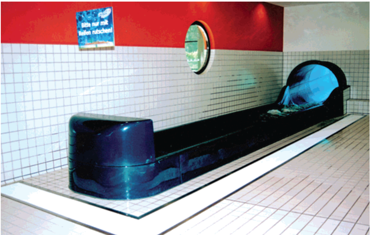
Sicherheits-Flachauslauf Typ RSS 95, in platzsparender, schmaler Ausführung aus GfK, ca. 6 m lang, ca. 1,4 m breit, Farbe: nach Wahl. Es kann problemlos auf gefliesten Boden aufgedübelt werden.
